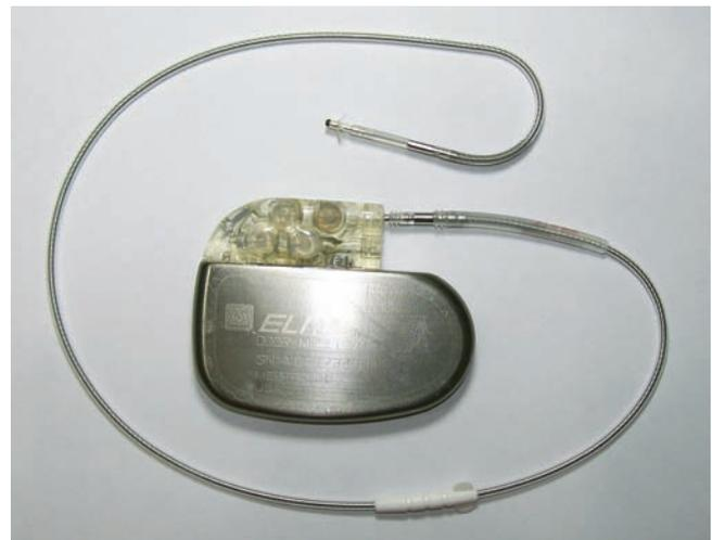
Figura No 1. Marcapasos cardíaco. Se observa la fuente y el electrodo.
